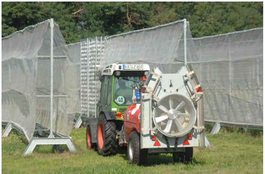
Bild 3: Anlagerungsmessungen in der Modellanlage zur Bewertung von Sprühgeräten; Quelle: Christian Göppinger
