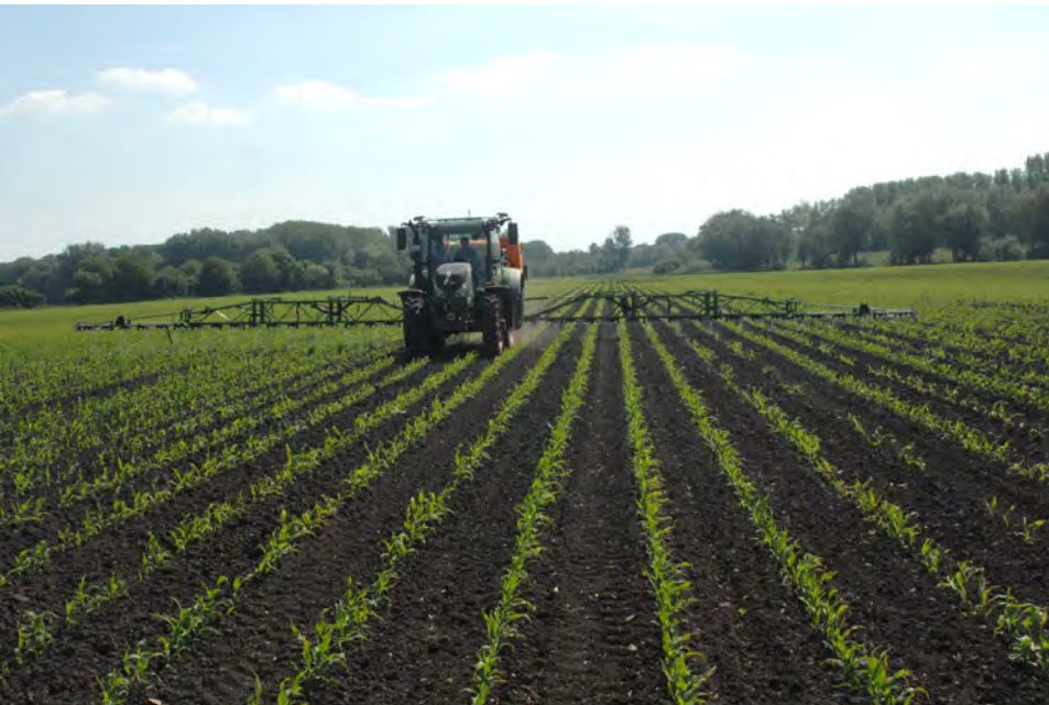
Bild 2: Bandapplikation im Mais mit 66 % PSM-Einsparung; Quelle: Roland Bahmer
