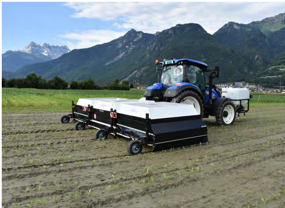
Bild 1: Spot Spraying Gerät ARA bei der Unkrautbekämpfung in Zuckerrübe; Quelle: Ecorobotix SA
