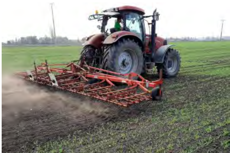
Abb. 4: Ein Striegeleinsatz im Getreide spart den Einsatz von Herbiziden; Quelle: Andreas Willhauck, LTZ
